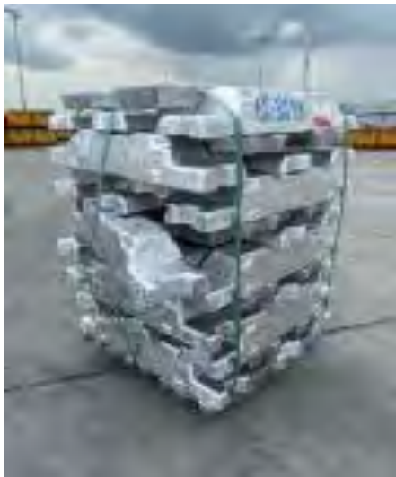
Ingot มีความเสี่ยงจะหล่น 落下の恐れがある地金
